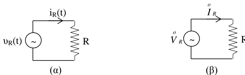
Σχήμα 4.11: Κύκλωμα R (α) στο πεδίο του χρόνου και (β) στο πεδίο της συχνότητας.
