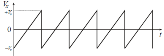
Σχήμα 3α: Η εσωτερική πριονωτή τάση που εφαρμόζεται στον πυκνωτή οριζόντιας απόκλισης.
