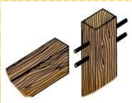
Γωνιακή σύνδεση με καβίλια
