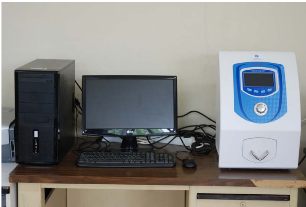
Εικόνα 1. Αναλυτής φασμάτων ανάκλασης ακτινοβολίας πλησίον του υπέρυθρου (NIR) (Model SpectraAlyzer, ZEUTEC OPTO-ELEKTRONIK GmbH, Rendsburg).
