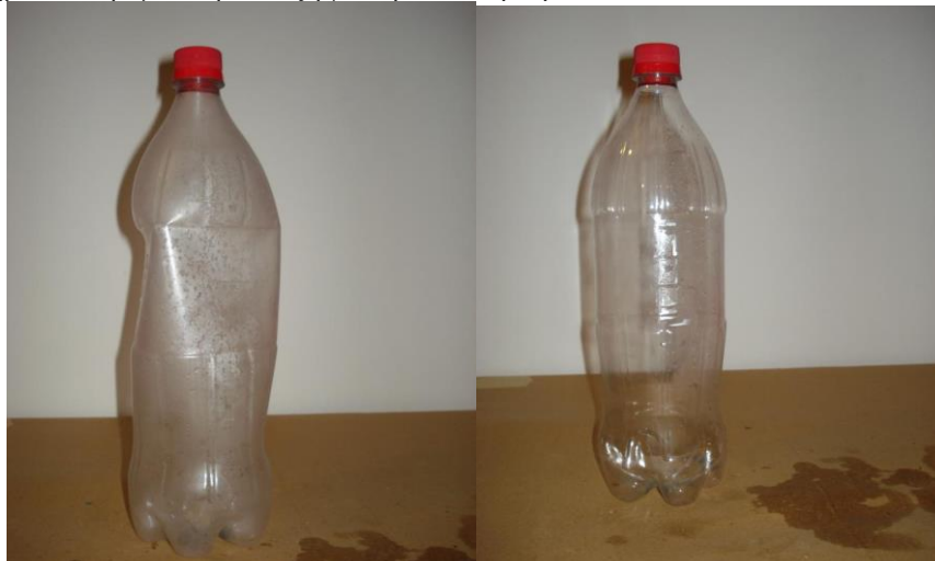
Σχήμα 9: πειραματική διάταξη για τη συστολή αερίων.
