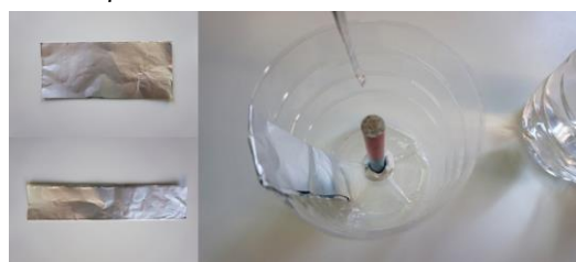
Εικ. 9: Διαμόρφωση λωρίδας αλουμινόχαρτου και στήριξη της στο πλάι του δοχείου με το μαγνήτη, που αργότερα ρίχνουμε και το αλατόνερο.
