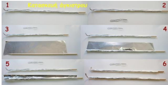
Εικ. 7: Κατασκευή άξονα στήριξης του καλωδίου, με ένα ξύλινο καλαμάκι ή λεπτό ξυλάκι, το οποίο τυλίγουμε με λωρίδα αλουμινόχαρτου και διαμορφώνουμε κατάλληλα ένα άγκιστρο στήριξης στην μία του άκρη.
