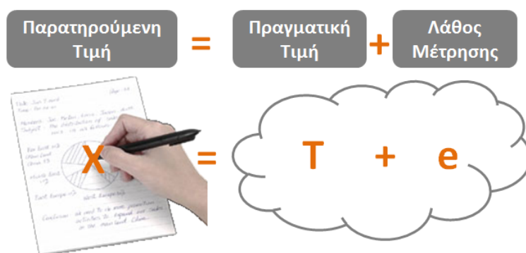
Εικόνα 2.10 Σχέση μεταξύ παρατηρούμενης τιμής (x), πραγματικής τιμής (T) και λάθους της μέτρησης (e)
