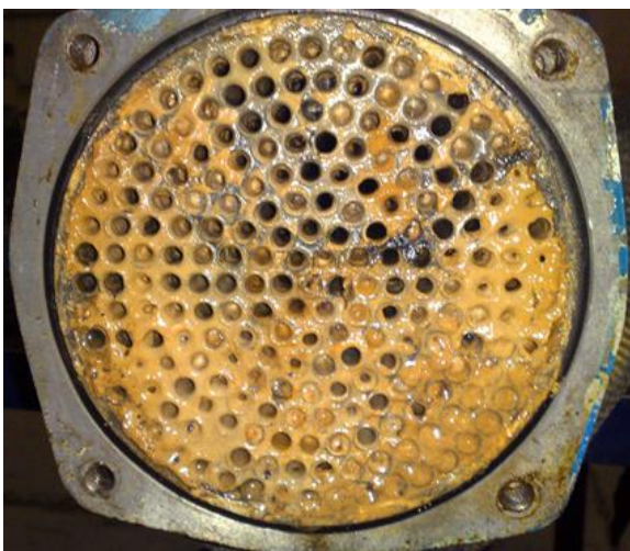
Σχήμα 2.1: Σχηματισμός αποθέσεων σε αυλούς εναλλάκτη θερμότητας.
