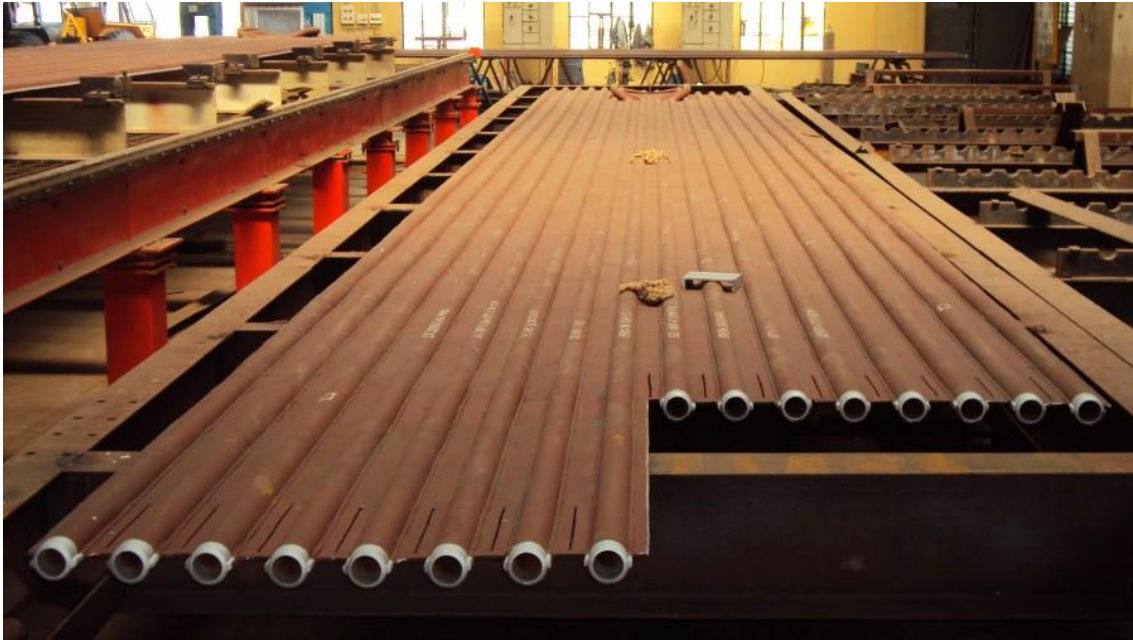
Σχήμα 11.12: Συστοιχία αυλών που επενδύει τον χώρο καύσης/ακτινοβολίας αμοπαγωγού.
