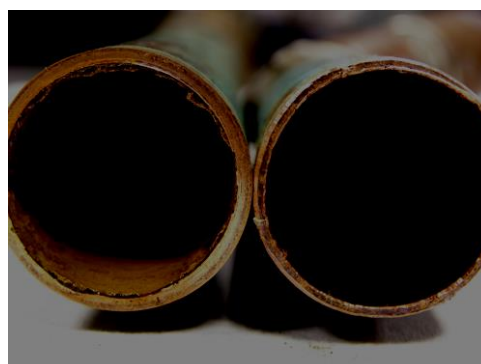
Σχήμα 2.1: Σχηματισμός αποθέσεων σε αυλούς εναλλάκτη θερμότητας.
