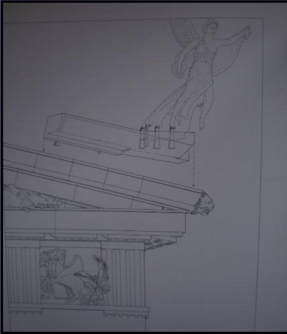
Πλάγιο ακρωτήριο Παρθενώνος με μορφή Νίκης. Συνοπτικό διάγραμμα που δείχνει τις οπτικές εκλεπτόνσεις του κτηρίου. Σχέδια Μ. Κορρέ.
