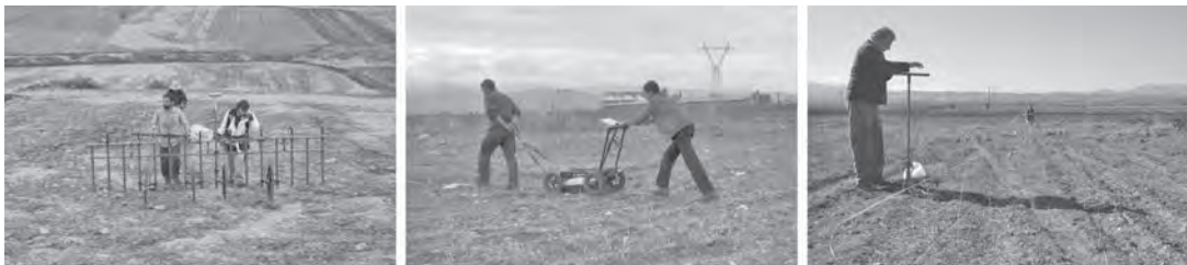
Εικ. 2. Εφαρμογή μαγνητικών διασκοπήσεων με χρήση διάταξης πολυμαγνητικών αισθητήρων (αριστερά), του γεωαραντά (κέντρο) και της πυρηνοληψίας εδάφους (δεξιά)
