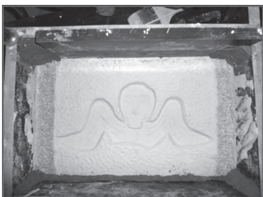
Εικ. 9. Καλούπι από σιλικόνη για την κατασκευή αντιγράφων.
