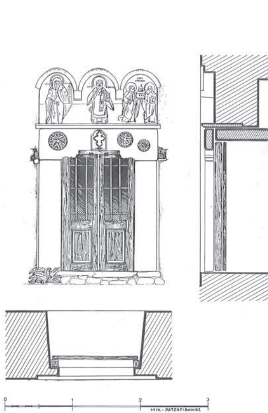
Εικ. 9. Το θύρωμα της δυτικής όψης, πριν την αποκατάσταση.
