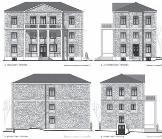
Εικ. 9. Οι όψεις του κτιρίου. Πρόταση αποκατάστασης.
