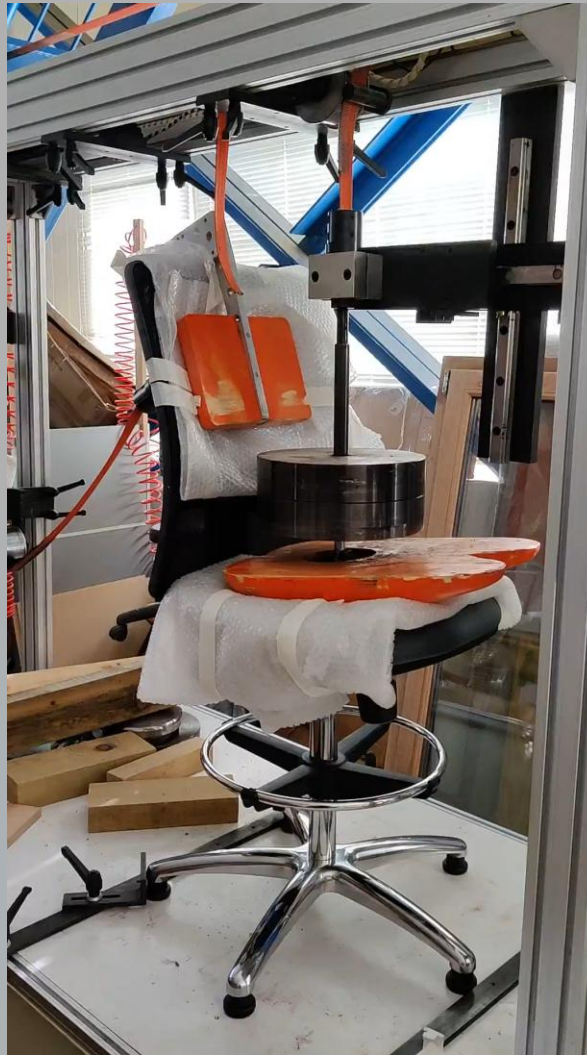
Δοκιμή ανθεκτικότητας καθίσματος και πλάτης
