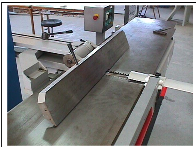
Εικ. 4.6. Οδηγός με κλίση σε πλάνη για λοξά πλανίσματα.
