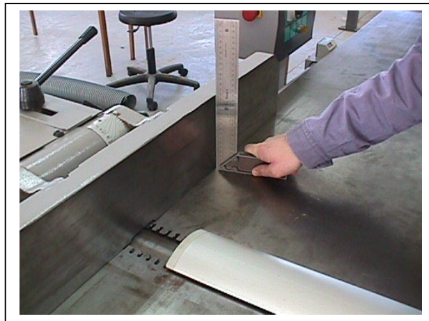
Εικ. 4.4. Έλεγχος της καθετότητας του οδηγού.
