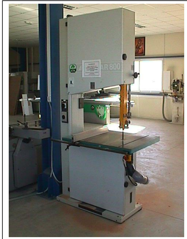
Εικ. 2.1. Ταινιοπρίονο επανάπρισης με σταθερή τράπεζα που συναντάται σε επιπλοποιεία.
