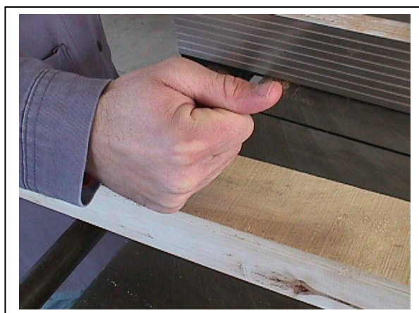
Εικ. 2.4. Τα χέρια του χειριστή είναι κλειστά σε γροθιά καθόλη τη διάρκεια της κατεργασίας με μικρή προεξοχή του αντίχειρα.
