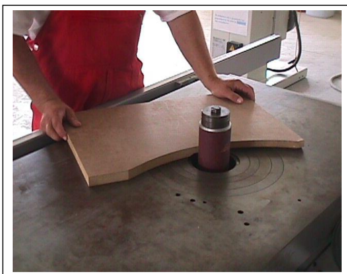
Εικ. 6.7. Λείανση καμπύλων επιφανειών με τριβείο κυλίνδρου τοποθετημένο σε άξονα της σβούρας.
