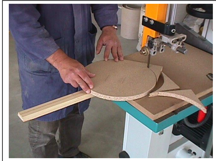
Εικ. 2.12. Δημιουργία κυκλικής επιφάνειας με ιδιοσκευή.
