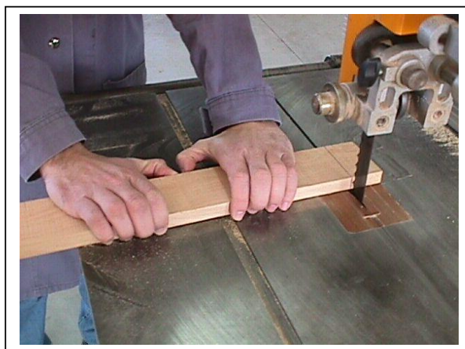
Εικ. 2.7. Ξεμάκρυνση πριστοτεμαχίου με την πλατιά επιφάνεια να εφαρμόζει στην τράπεζα εργασίας.
