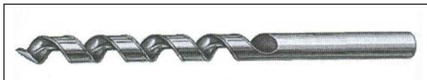
Εικ. 7.6. Τρυπάνι διάνοιξης οπών μεγάλου βάθους σε μασίφ ξυλεία.
