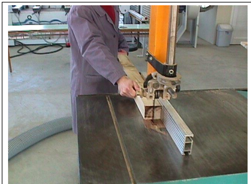
Εικ. 2.2. Η ενδειγμένη στάση του χειριστή στο ταινιοπρίονο κατά την εκτέλεση πρίσεων κατά μήκος των ινών του ξύλου.
