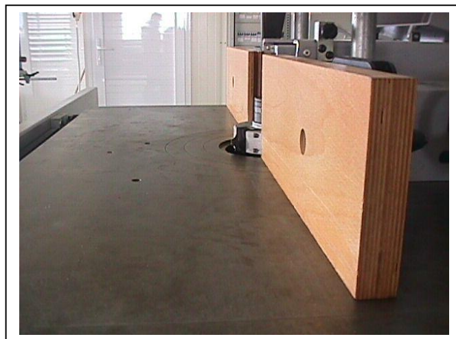
Εικ. 6.3. Ευθυγράμμιση και ρύθμιση των οδηγών.
