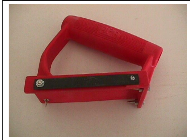
Εικ. 4.9. Ειδικός προωθητήρας για το πλάνισμα μικρών ξυλοτεμαχίων.
