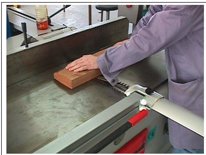
Εικ. 1.2. Επικίνδυνος χειρισμός της πλάνης. Ο χειριστής έχει ξεχειλωμένα μανίκια και δεν τοποθέτησε τα προστατευτικά.
