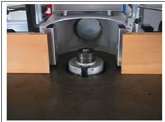
Εικ. 6.2. Κοπτικό που ένα τμήμα του προεξέχει πάνω από την τράπεζα εργασίας.
