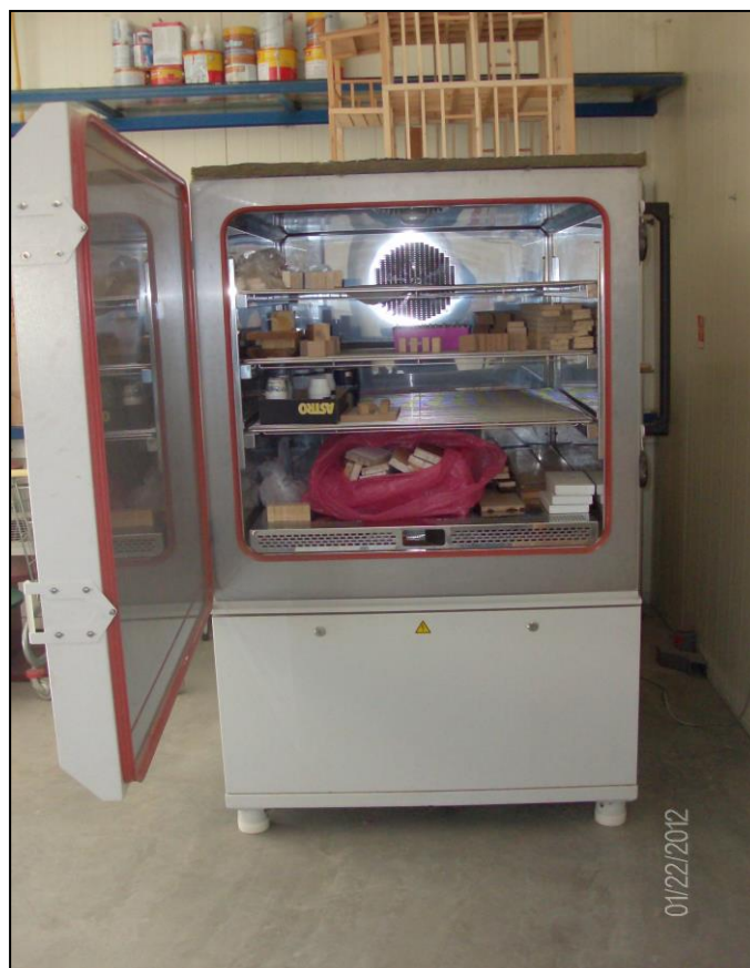
Μεγάλος θάλαμος κλιματισμού
