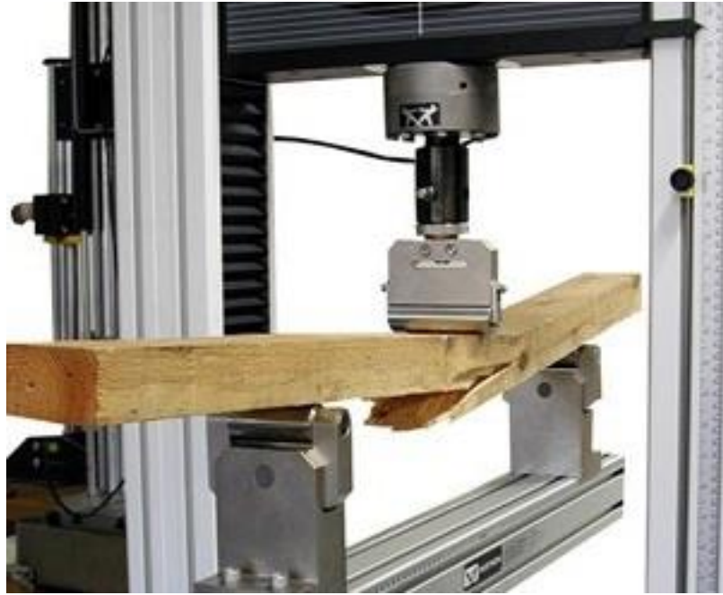
ΣΧΗΜΑ 14Α. Φόρτιση ξύλου (καδρονιού) σε δυνάμεις στατικής κάμψης.
