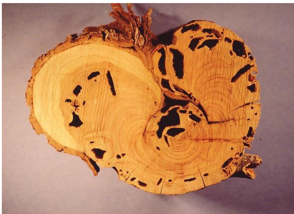
ΕΙΚΟΝΑ 9. Έντονη προσβολή κορμιδίου από τερμίτες (termites).
