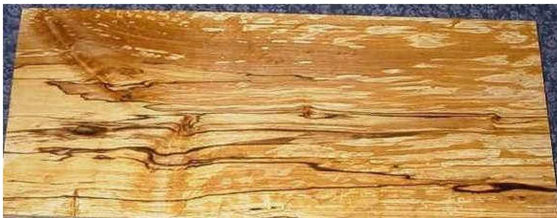
ΕΙΚΟΝΑ 3Α. Τυπική εμφάνιση λευκής σήψης σε ξυλεία.
