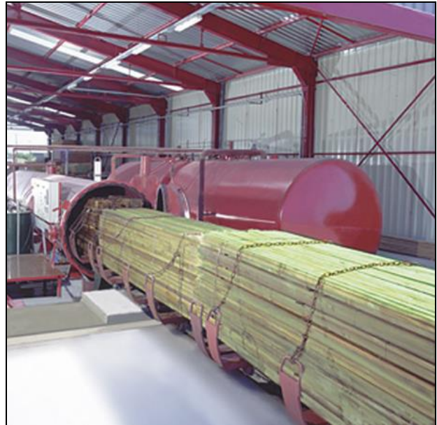
Θάλαμος εμποτισμού ξυλείας υπό υψηλή πίεση
