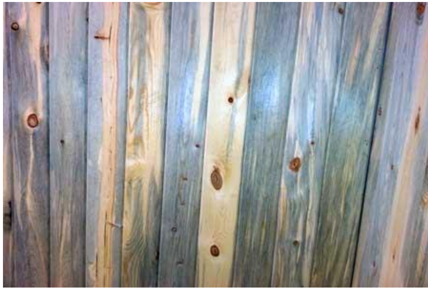
ΕΙΚΟΝΑ 2Α. Προσβολές κύνωσης ξύλου σε διάφορα δοκίμια πεύκων.
