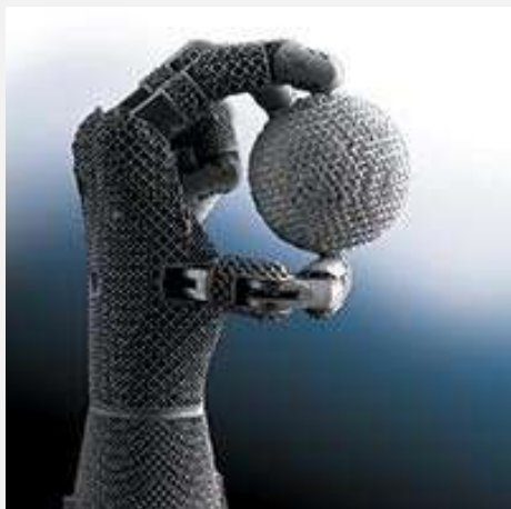
Ρομποτικός βραχίονας φτιαγμένος σε 3D εκτυπωτή
