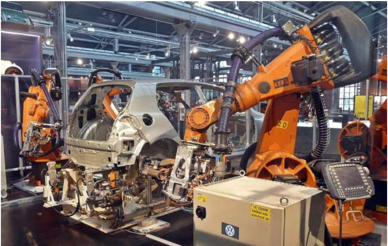
Εικόνα 9.28 Βιομηχανικά ρομπότ σε γραμμή συναρμολόγησης αυτοκινήτων (Πηγή: Wikimedia Commons, File:Industriemuseum Chemnitz-moderne Karosserieschweißanlage_mit_Industrierobotern.jpg).
