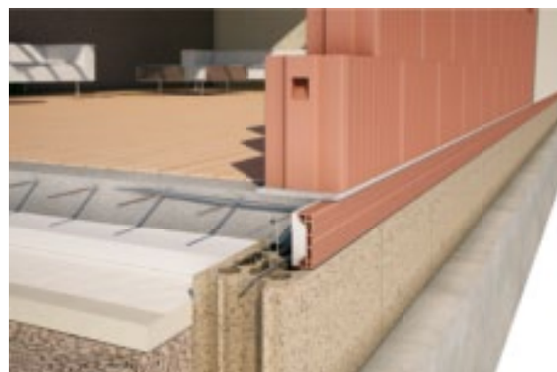
Plancher bas sur terre-plein avec dalle pleine
