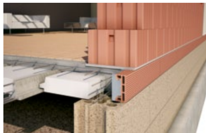
Plancher bas sur vide sanitaire avec hourdis isolant
