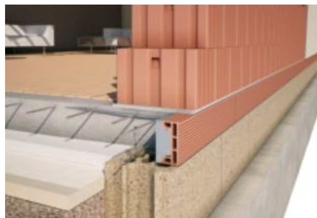
Plancher bas sur terre-plein avec dalle pleine
