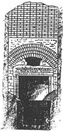
Εικ. 211. Πολλαπλό πλίθρινο ανακουφιστικό τόξο σε αρχαίο τάφο (Maspero, σ. 124, εικ. 130).
