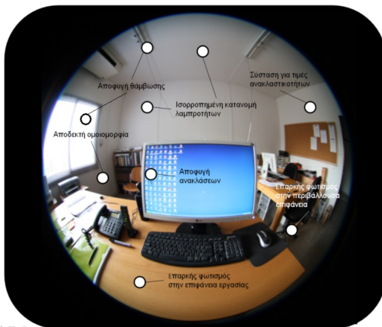
Σχήμα 6.1: Σημεία στα οποία πρέπει να δοθεί προσοχή κατά τη διάρκεια του σχεδιασμού για την αποφυγή οπτικής δυσφορίας.
