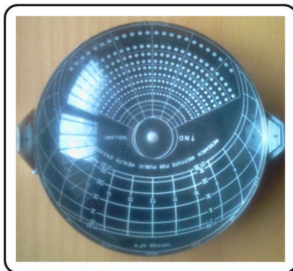
Σχήμα 3.12: Συσκευή εκτίμησης φυσικού φωτισμού (αριθμός κουκίδων που σχηματίζονται στο είδωλο του παραθύρου) και ηλιακών ιχνών (τομή ειδώλου παραθύρου με ηλιακό διάγραμμα).
