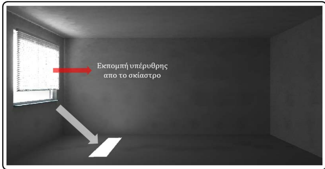
Σχήμα 7.55: Απορρόφηση ηλ. ακτινοβολίας από το σύστημα σκίασης, αύξηση της θερμοκρασίας του και συνεπώς αύξηση στην εκπομπή υπέρυθρης ακτινοβολίας από αυτό.
