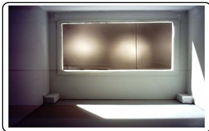
Σχήμα 5.6: Παρατηρήστε τις διαστάσεις των πηγών φωτισμού. Λόγω των πεπερασμένων διαστάσεων τους αν η μακέτα έχει μεγάλες διαστάσεις, οι μετρήσεις επηρεάζονται από σφάλματα παράλλαξης.
