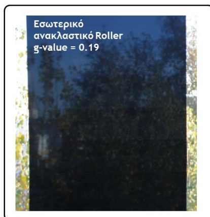
Σχήμα 7.66: Ανακλαστικό εσωτερικό σκιάδιο. Η όψη (προς το εξωτερικό) είναι ανακλαστική συνεπώς ανακλά την μικρού μήκους ακτινοβολία πάλι προς το εξωτερικό περιβάλλον ενώ επιτρέπει την οπτική επαφή με αυτό.
