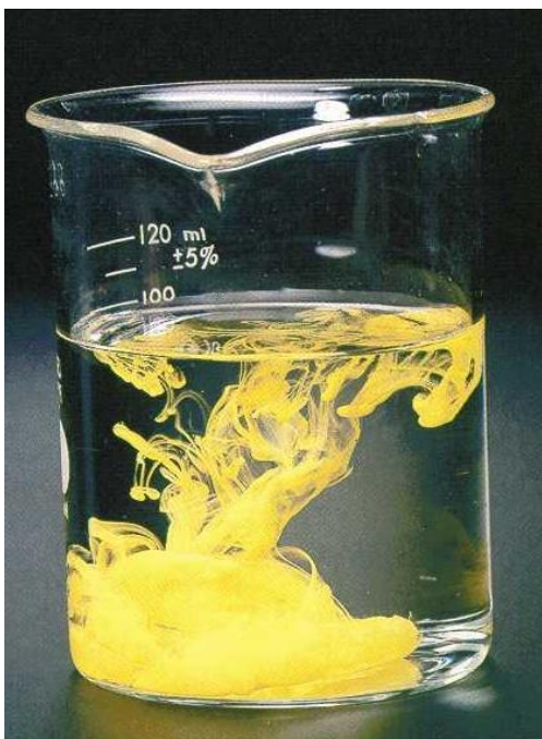
Σχήμα 13. Μη σωστή ανάμειξη όπου η συγκέντρωση της ουσίας μπορεί να κυμαίνεται στο διάλυμα από \approx 0\% στα επιφανειακά στρώματα του διαλύματος, έως 100\% στο βυθό του διαλύματος.
