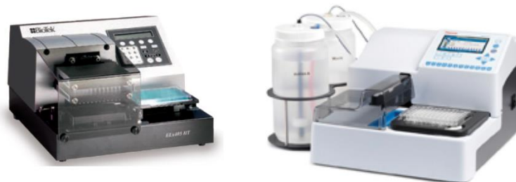
Φωτογραφία 6.3 Αυτόματα πλυστικά ELISA διαφόρων εταιρειών (Biotek, Thermo). Αν και η έκπλυση των πλακών ELISA μπορεί να γίνει και χειρονακτικά με τη βοήθεια οκτακάναλης πιπέτας, το αυτόματο πλύσιμο είναι γρήγορο και αποτελεσματικό.
