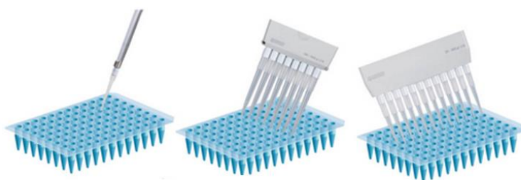
Σχήμα 6.11 Τύποι πιπετών που μπορούν να χρησιμοποιηθούν σε δοκιμασίες ELISA. Πιπέττες με ένα, οκτώ ακόμα και με δώδεκα ρύγχη μπορούν επίσης να χρησιμοποιηθούν.
