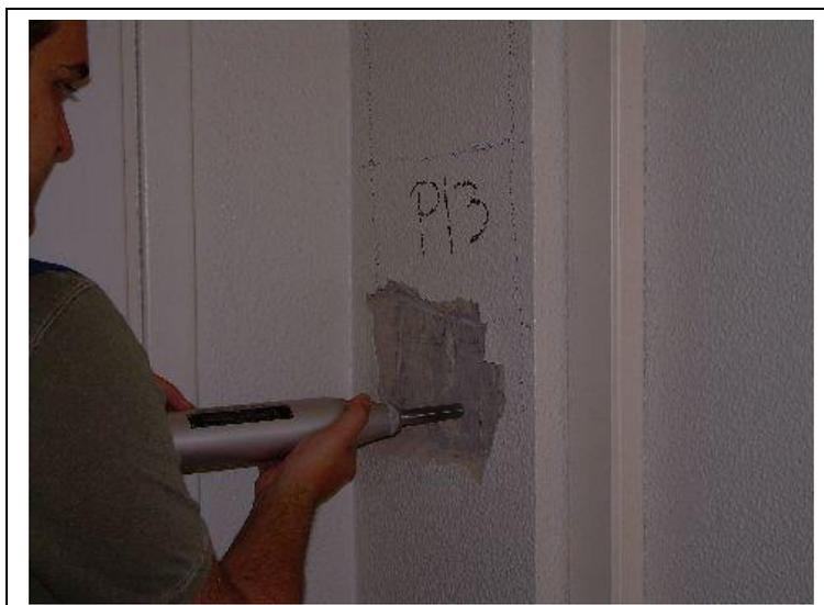
**7] ΔΟΚΙΜΗ ΦΟΡΤΙΣΗΣ ΣΧΙΣΜΗΣ - ΔΟΚΙΜΗ ΠΕΔΙΟΥ - ΜΗ ΚΑΤΑΣΤΡΟΦΙΚΗ**
