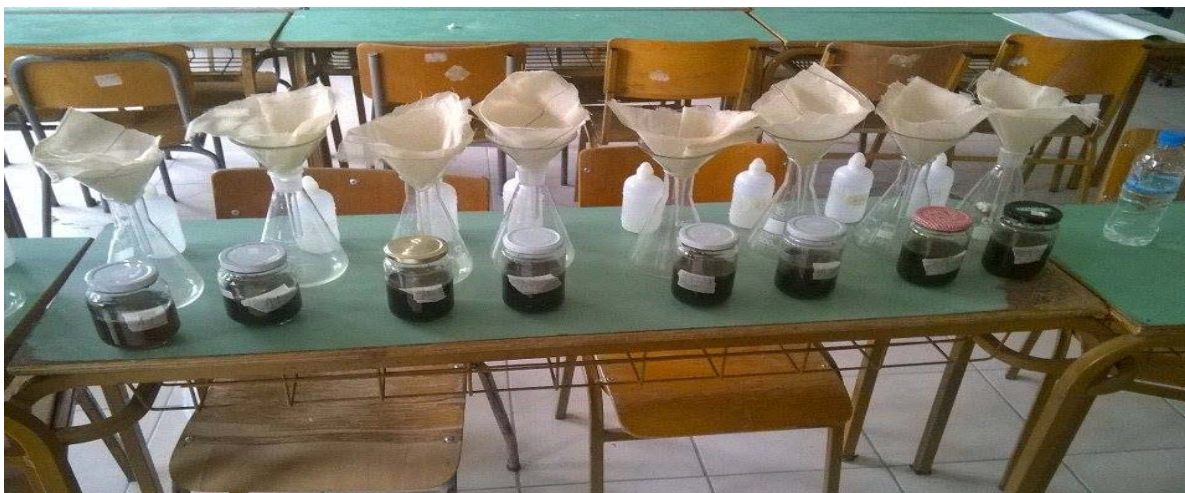
Εικόνα 3. Διήθηση εκχυλισμάτων από τουρλοπάνι.
