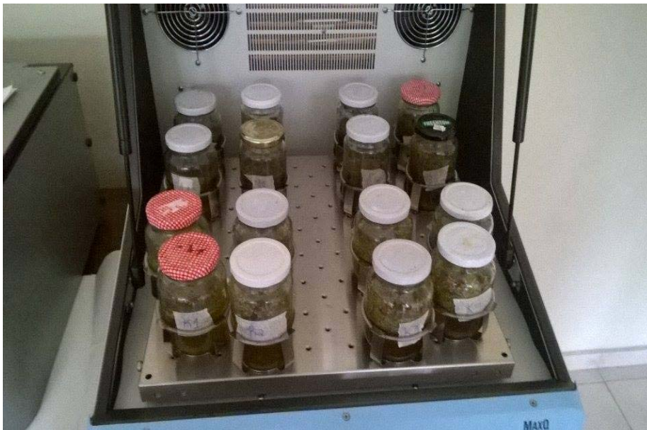
Εικόνα 2. Ανακίνηση βάζων για 4 ώρες σε θερμοκρασία 21 °C.
