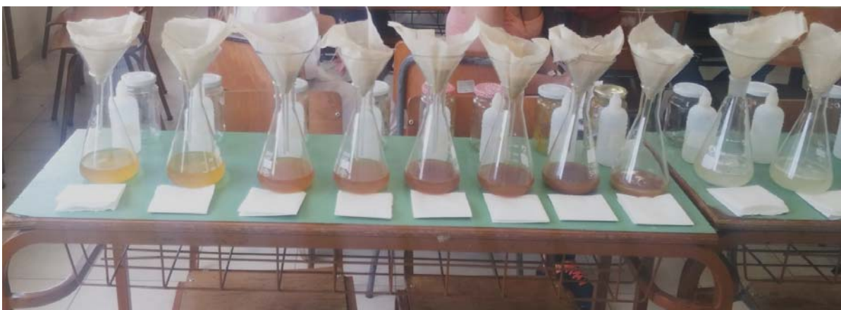
Εικόνα 4. Διήθηση εκχυλισμάτων από διηθητικό χαρτί.
