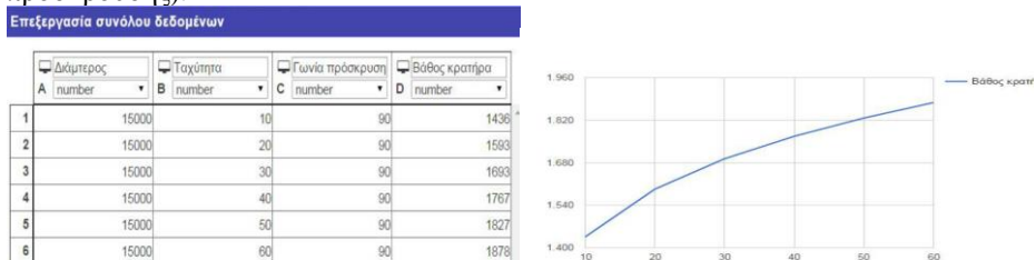
Εικόνα 1 : Πίνακας τιμών για την μεταβολή της ανεξάρτητης μεταβλητής της ταχύτητας σε σχέση με την εξαρτημένη μεταβλητή του βάθους του κρατήρα και αποτύπωση των μεταβολών στην αντίστοιχη γραφική παράσταση.
