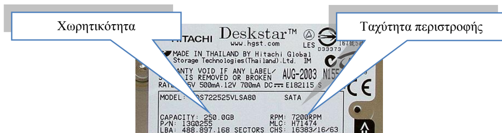
Σχήμα 2.3: Ετικέτα στο πάνω μέρος ενός σκληρού δίσκου.
