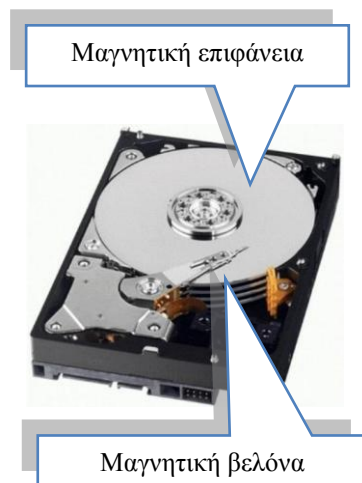
Σχήμα 2.2: Εσωτερικό σκληρού δίσκου.
