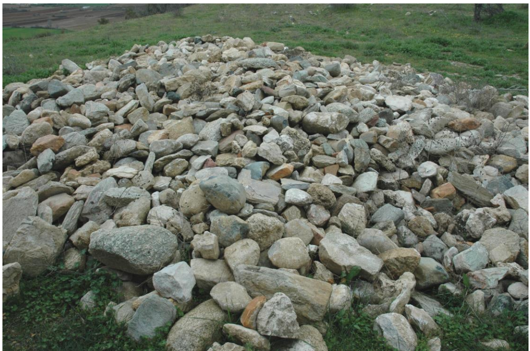
Υφιστάμενο υλικό που θα χρησιμοποιηθεί για τις πέτρινες τοιχοποιίες
