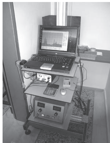
Εικ. 2. Το ολοκληρωμένο σύστημα XRF που έχει εγκατασταθεί στο εργαστήριο συντήρησης του μουσείου του Βόλου.
