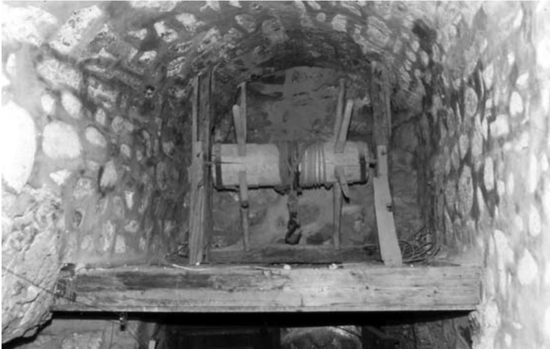
Εικ. 8. Η Τρίτη Οδός προσπελάσεως στη μονή Βαρλαάμ: το βαρούλκο in situ, προ της κύριας εισόδου της για την ανάσυρση της παλαιάς κινητής ξύλινης γέφυρας.
