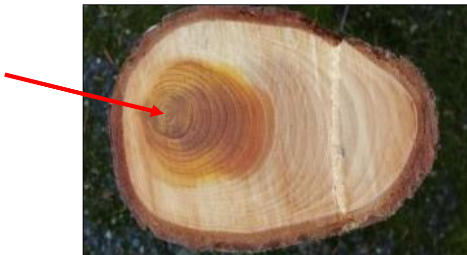
ΕΙΚ. 43. Έκκεντρη τοποθέτηση της εντεριώνης σε κορμό δρύος.
