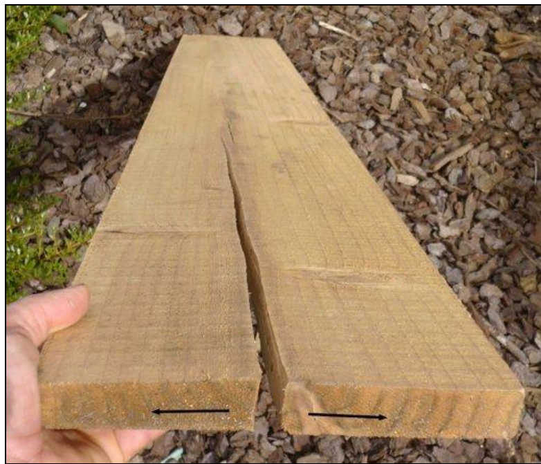
ΕΙΚ. 41. (A). Κατά μήκος τομή εντεριώνης σε πιστό οξιάς (ακατάλληλο), (B). Ραγάδα σε πιστό ακριβώς στην εντεριώνη (λόγω των αντίθετων τάσεων κατά την ξήρανση).
