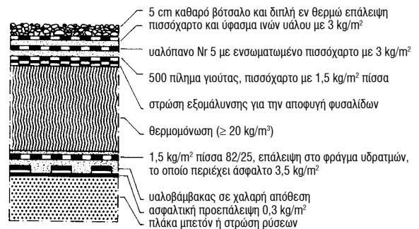
10 Συνήθης κατασκευή θερμού δώματος
