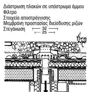
13 Φρεάτιο ελέγχου απορροής
